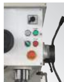
Avanzamento automatico canotto (IME-MPA40TM)
